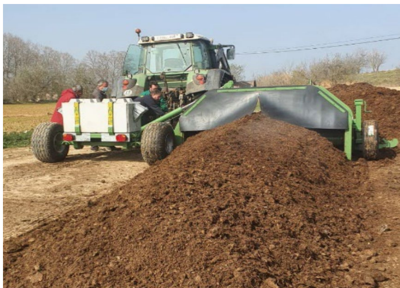
Imatge 11. Màquina de volteig de compost. Font: Consorci de l'Espai Natural de Gallecs.
